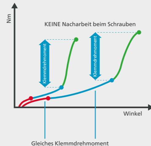
Korrektes Klemmdrehmoment angewendet – keine Nacharbeit erforderlich
